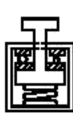
Рисунок 18 — Примеры безвинтовых контактных зажимов пружинного типа
