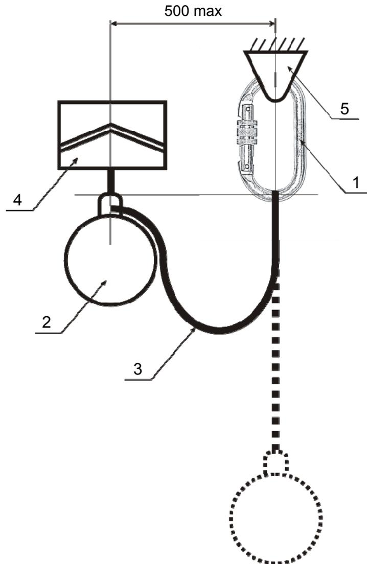
1 — карабин; 2 — контрольный груз; 3 — фал; 4 — расцепляющее устройство; 5 — опора;
