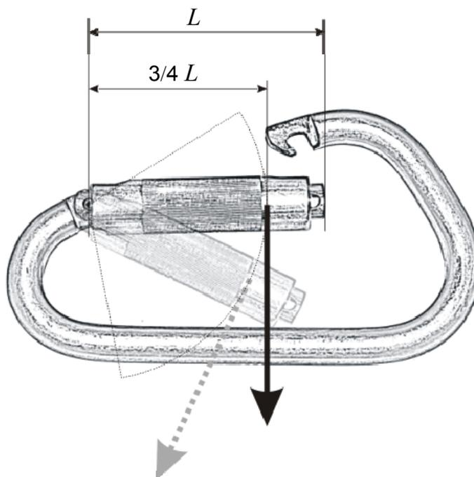
Рисунок 2 — Схема испытания усилия раскрытия затвора карабина
