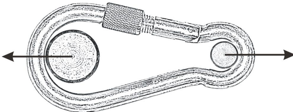
Рисунок 3 — Схема нагружения карабина по линии главной оси
